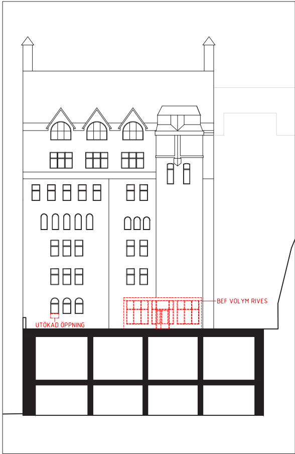
SEKTION B - BEFINTLIG FASAD RIVNING
